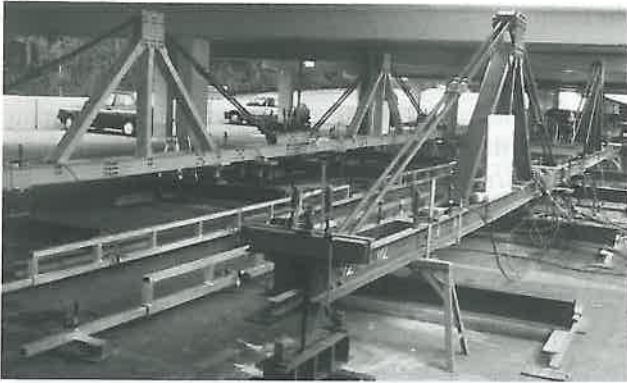
Abb. 33: Belastungsrahmen in Tandem-Anordnung für feldweise wechselnde Verkehrslast
