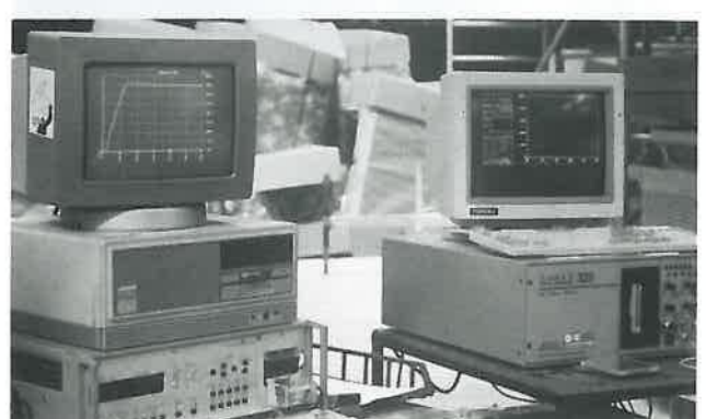
Abb. 30: Meßstand mit Kraft-Weg-Messung (links) und Schallemissionsmessung (rechts)
