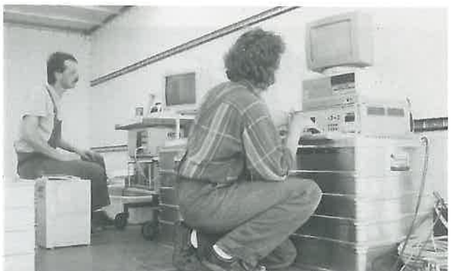
Abb. 22: Mobiler Meßstand im LKW: Schallemissionsmessung und Kraft-Verformungsmessung am Brückenüberbau
