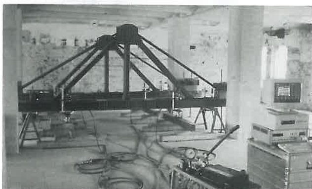
Abb. 40: Belastungsrahmen mit Lastverteilungsgeschirr, Hydraulik und On-Line-Meßanlage
