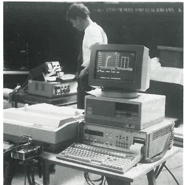
Abb. 1: Mobile Meßanlage (60 Meßstellen) mit PC, Monitor und Drucker
