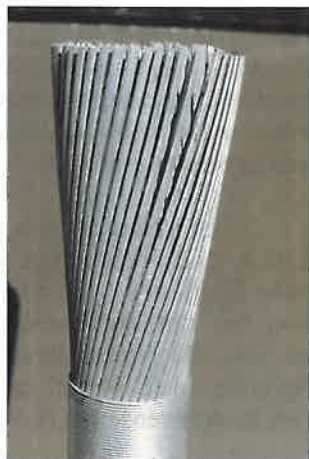
Abb. 4: Seilbesen zur Verankerung in einer Vergusschülse
