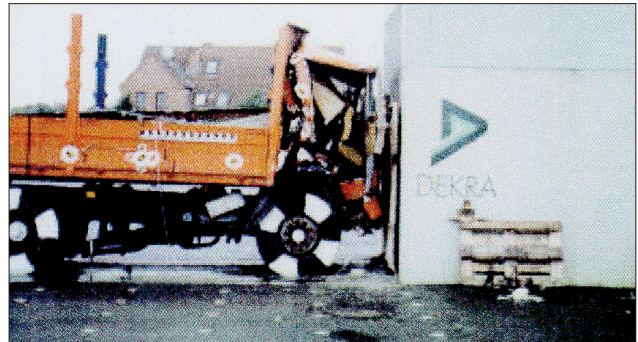
Abb. 2: Crash-Versuche LKW an starre Wand, DEKRA (Internet)
