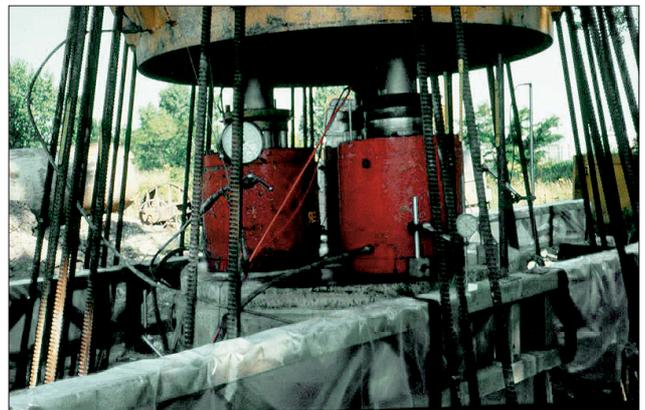
Abb. 5: Probelastung: Pfahlkopf, Pressen, Messeinrich- tungen und Traverse für Widerlager für Bohrpfahl  $d = 150 \text{ cm}$
