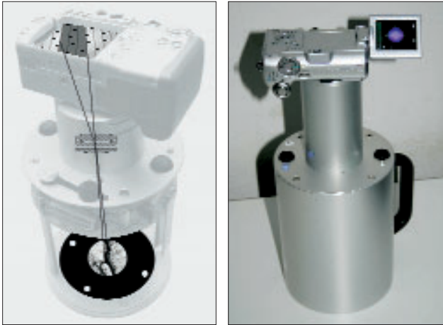
Abb. 5: Links: Prinzip der zentralperspektivischen Abbildung eines Risses auf den CCD-Sensor einer Digitalkamera. Dargestellt sind auch die Kontrollpunkte zur Überprüfung der Kamerakalibrierung. Rechts: DRS- Hardware bestehend aus Kamera und Tubus.
