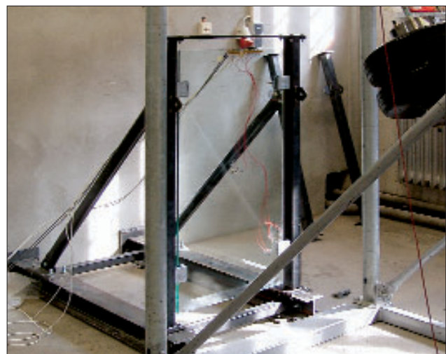
Abb. 4: Experimenteller Nachweis der Stoßsicherheit. © Institut für Baukonstruktion, Technische Universität Dresden
