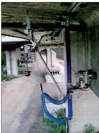
Abb. 7 (a): Von der BAM entwickelter Brückenscanner bei der Messung an einer Hohlkastenaußenwand; (b): Vergleich von Bestandsplan und Messergebnissen: mit Ultraschallecho ermittelte Lage von Spanngliedern nach SAFT-Rekonstruktion [24]
