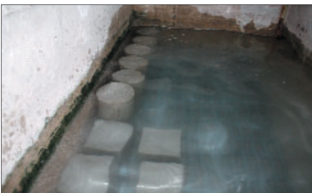
Abb. 4: In Wasser gelagerter Probekörper
