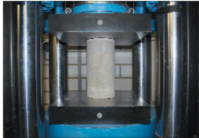
Abb. 2: Druckfestigkeitsprüfung an Betonzylindern
