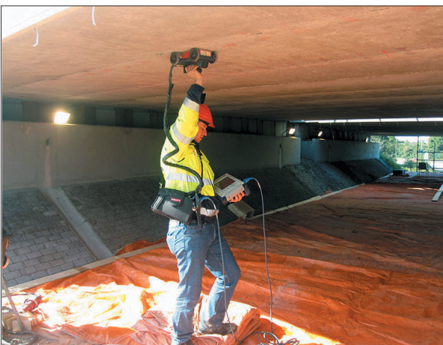
Abb. 9: Zustandsbeurteilung einer bestehenden Konstruktion
