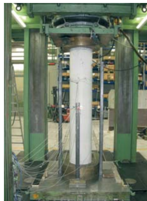
Abb. 18: Versuchsaufbau und Versagenszustand der Referenzstütze
