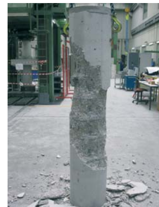
Abb. 18: Versuchsaufbau und Versagenszustand der Referenzstütze
