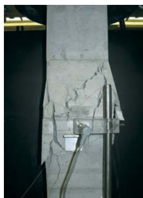
... 20 mm (V6) –Verguss mit hochfestem Mörtel C80
