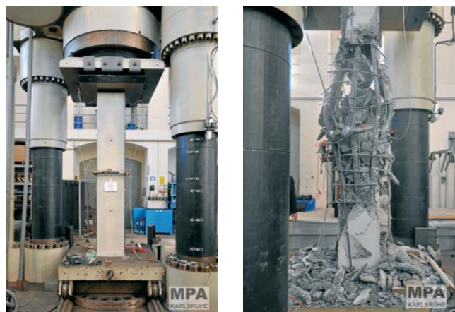
Abb. 27: Versuch V 15: Referenzstütze vor und nach dem Versuch
