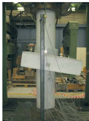
Abb. 19: Versuchsaufbau und Versagenszustand einer gestoßenen Stütze
