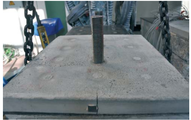
Abb. 29: Eindrückungen der Mörtelfuge nach dem Bruch bei Versuch V17
