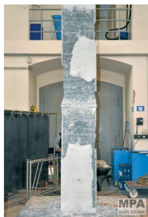
Abb. 28: Versuch V16 mit Stumpfstoß nach dem Bruch
