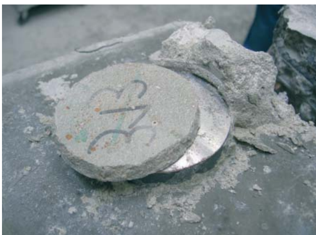
Abb. 12: Vergussmörtel beim Versuch V2 mit einer 6-mm-„Stahlfuge“
