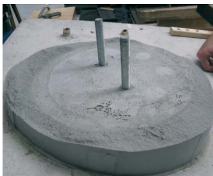
Abb. 20b: Guter Verguss mit Gewebe
