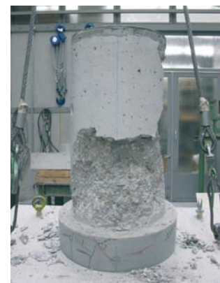
Abb. 19: Versuchsaufbau und Versagenszustand einer gestoßenen Stütze
