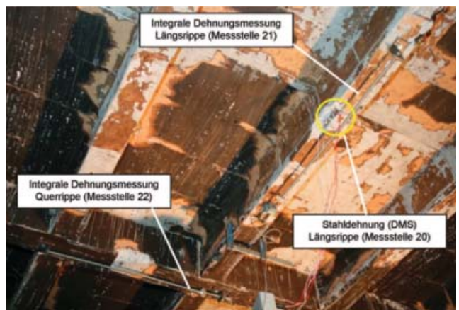
Abb. 20: Lage der Dehnungsmesspunkte an der Deckenunterseite
