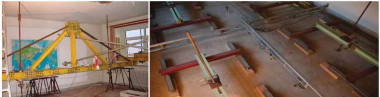
Abb. 18 (links): Lastverteilungsträger im EG mit Zugstangen und Hydraulikpressen; (rechts): Lastverteilung auf der zu prüfenden Decke
