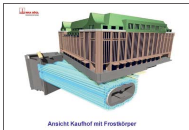
Abb. 5: Breite Tunnelquerschnitte, zum Beispiel für unterirdische Bahnhöfe, werden in mehreren Abschnitten aus einzelnen Froströhren zusammengesetzt.
