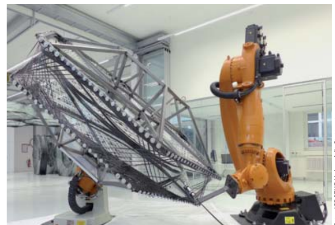
Abb. 12: Fertigung der Komponenten für den Elytra Pavilion
