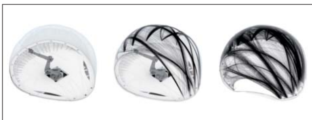
Abb. 8: Fertigungsprozess ICD/ITKE Forschungspavillon 2014-2015
