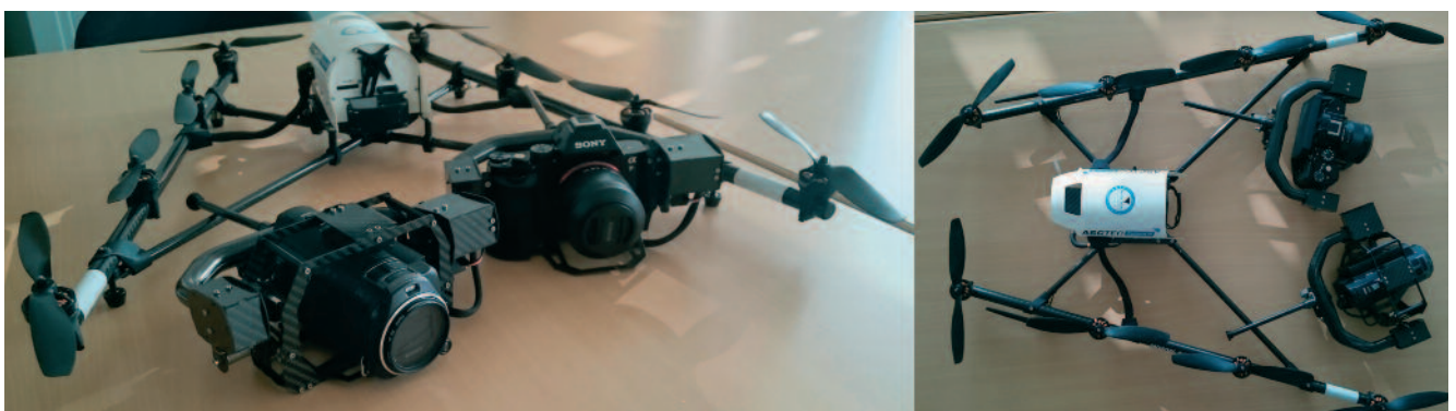
Abb. 2: Dem Labor für Ingenieurinformatik des Instituts für Mechanik und Statik der Universität der Bundeswehr München eigene Drohne „Falcon 8“ der Firma Ascending Technologies mit unterschiedlichen Sensoren
